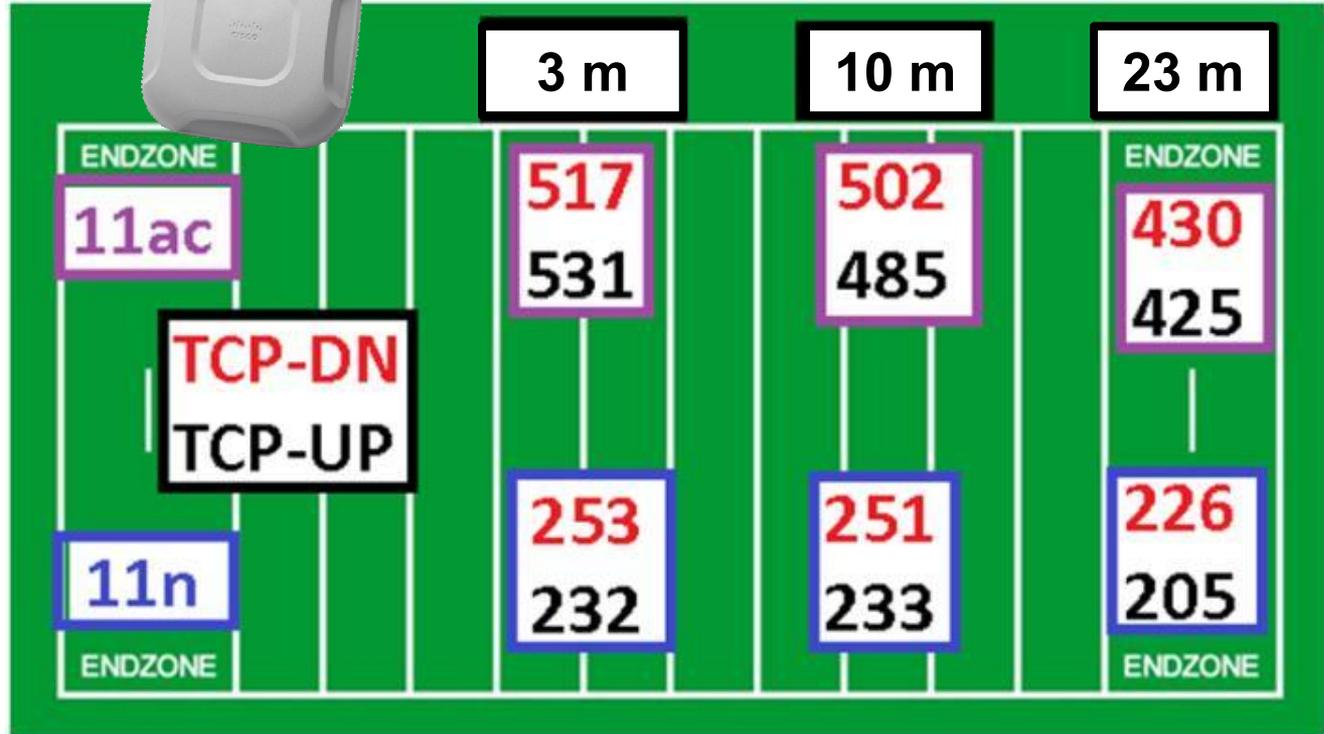
Un client 802.11ac @ 3-ss transmet donc globalement 2 fois vite plus qu'un client 802.11n à distance équivalente en environnement réel
