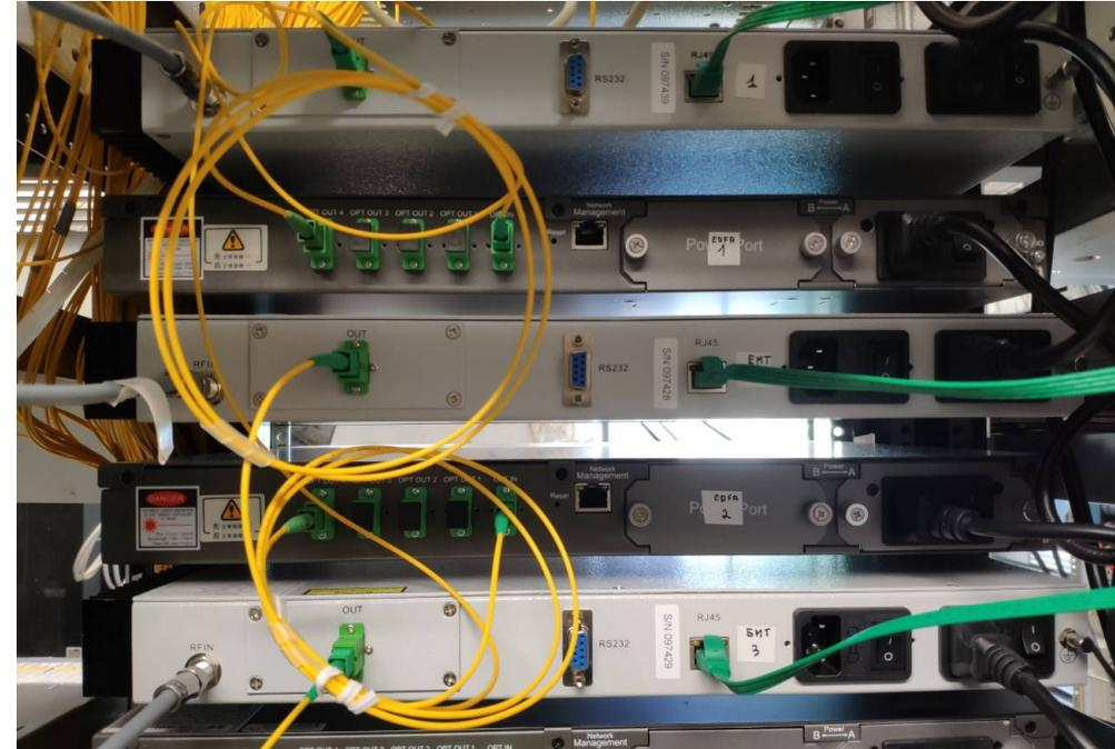
Protip hôtels : antenne rateau + modulateurs IP->DVB-T (chaines additionnelles) => ampli RF
